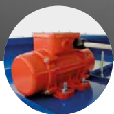
Motor shaker Oklep filtrů
