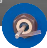
Sensors for min and max waste volume in hopper Senzor horní a spodní hladiny odpadu v násypce
